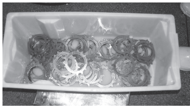
Figura 5 - Lâminas, peças integrantes da despolpadeira.
