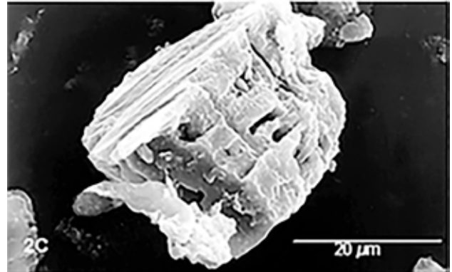
Figura 2 - Feições de abrasão e corrosão em feldspatos. 2A: abrasão e pontos de corrosão na face do cristal de feldspato; 2B: feição de abrasão e dissolução química; 2C: bordas e cantos do cristal corroído.
