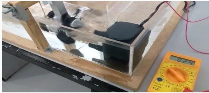
Figura 6 - Bancada gerando energia por meio da corrente d'água.
