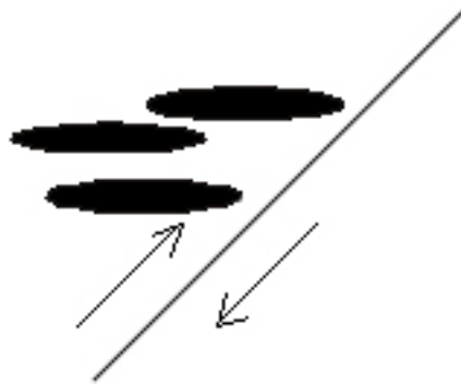
Figura 7 – Modelo de geração de fraturas extensionais associadas a cisalhamento, aplicado ao emplacement da suíte Aroeiras. Verificar o movimento destal da ZC Sobral-Pedro II.
