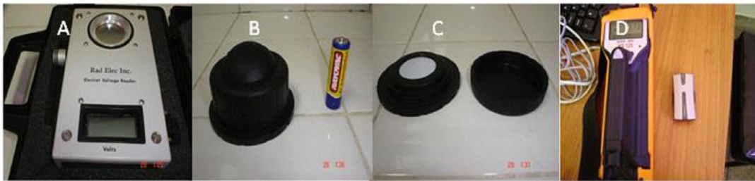
Fig. 2 - Componentes instrumentais do sistema do E-PERM® da RADELEC, que consistem no leitor do electree (A), câmara para electrete de longa duração (B e C); D) Espectrometro de radiação Gama, modelo RS-125 da TERRAPLUS.
