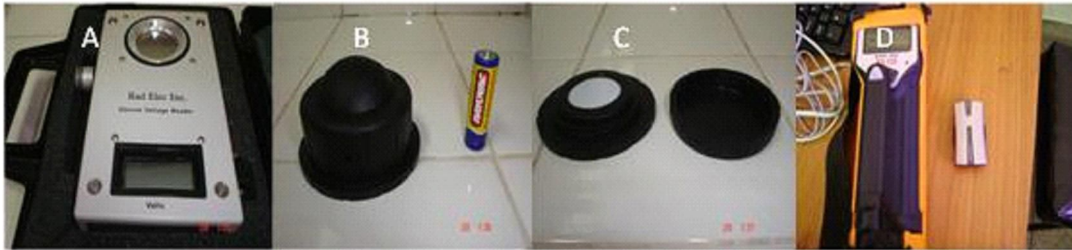
Fig. 2 - Os componentes do E-PERM® System da RADELEC, consistem no leitor do electret (A), câmara para electrets de longa duração (B e C); D) Espectrometro de radiação gama, Modelo RS-125 da Radiation Solution.
