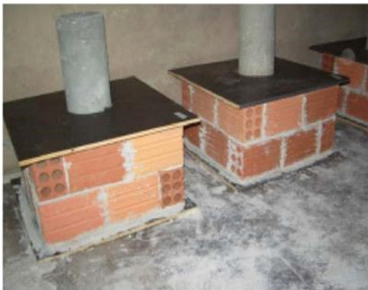
Fig. 4 – Modelo de solução utilizado na execução de testes para medição de concentração de gás radônio. Fonte: Fior (2008).
