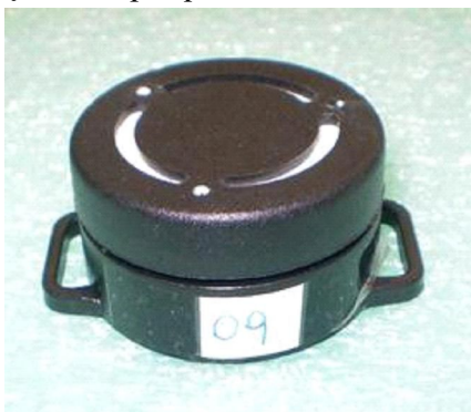
Fig. 1 - Câmara de difusão, pronta para uso, já com filtro e detector CR-39.
