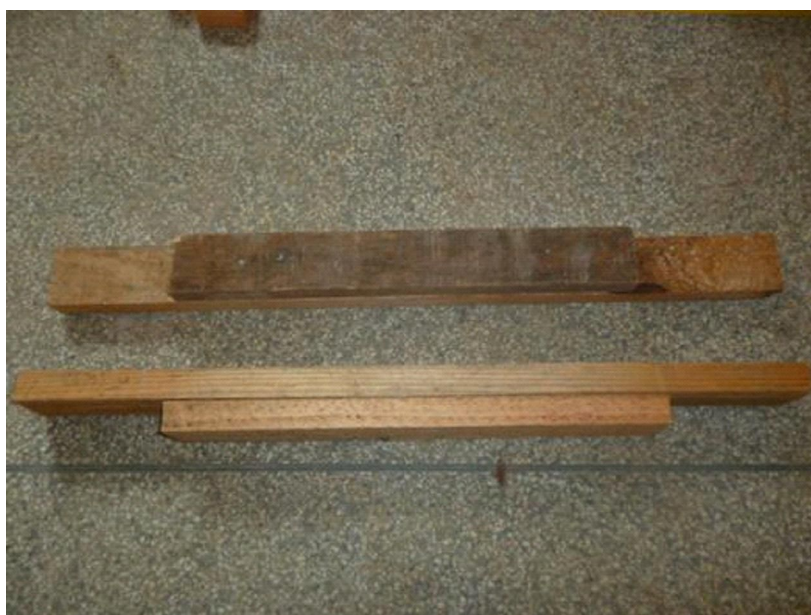
Figura 8 – Calços utilizados para auxiliar na montagem das laterais, com a finalidade de desnivelar o madeiramento estrutural.
