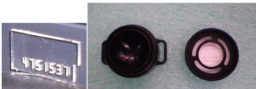
Fig. 2 - Da esquerda para direita: Detector CR-39; posicionamento do detector dentro da câmara de difusão. Fonte: Corrêa (2011).
