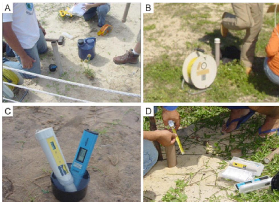
Fig.3 – Fotografias da etapa de aquisição dos parâmetros hidrogeológicos. A – Registro das anotações pertinentes ao piezômetro monitorado; B – Detalhes do medidor de nível; C – Momento da mensuração do pH e condutividade elétrica da água; e D – Medida da altura da “boca” do piezômetro.
