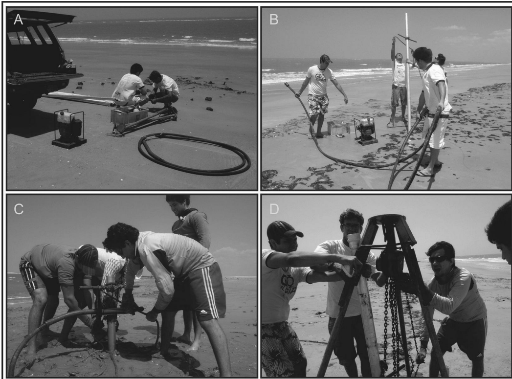
Fig. 3. Levantamento com Vibrocorer na linha de costa. Em (A) preparação inicial do equipamento. Em (B) seleção do local para perfuração. Em (C) tubo de alumínio inserido no substrato. Em (D) retirada do tubo com auxílio da talha montada no tripé. Nas fotografias nota-se o nível de paleomangue usado como base de referência.
