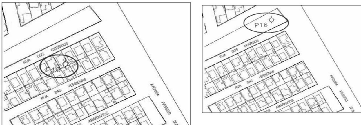
Fig. 01 - Poço (P-16) deslocado para dentro da quadra, entre o fundo de lotes (fig. à esquerda) e o mesmo poço locado na posição correta (fig. à direita).
