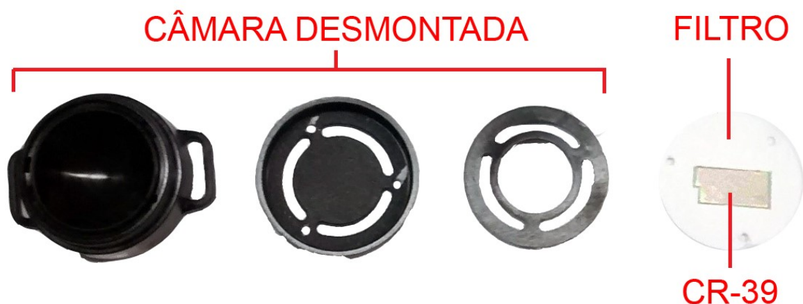
Figura 4: Câmara de difusão e detector CR-39.
