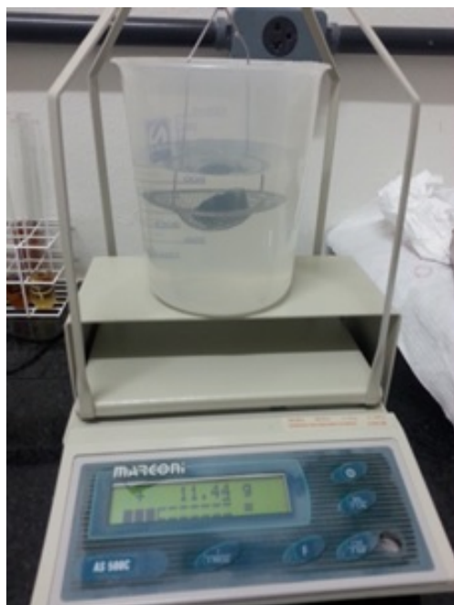
Figura 9 – Corpo de prova sendo pesado na balança hidrostática.
