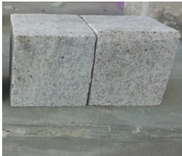
Figura 5 – Amostras de sienogranito utilizadas nos ensaios com dimensões de 7,0 X 7,0 X 7,0 cm.
