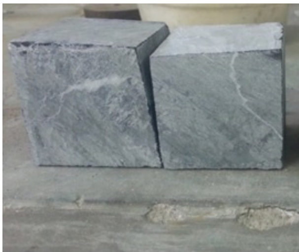
Figura 4 – Amostras do Diorito basáltico utilizadas nos ensaios com dimensões de 7,0 X 7,0 X 7,0 cm.
