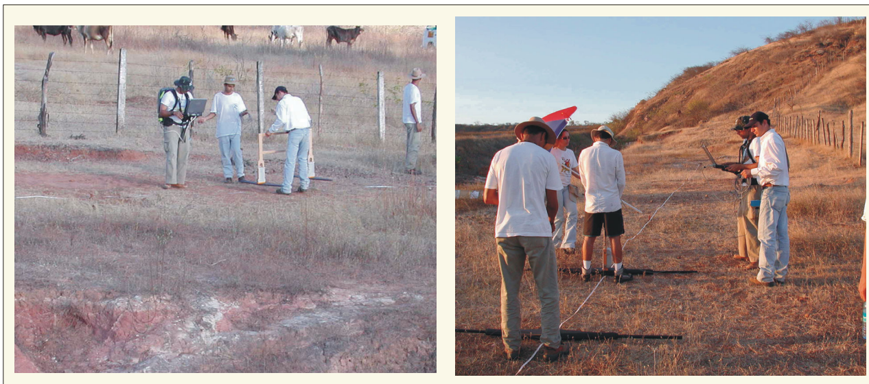
Figura 04 Detalhe dos perfis geofísicas com GPR, na porção inferior da escarpa.
