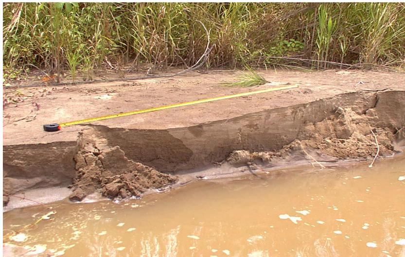
Figura 02 – Corte realizado para mensurar a profundidade alcançada (6 cm) pelo petróleo em 12 horas.
