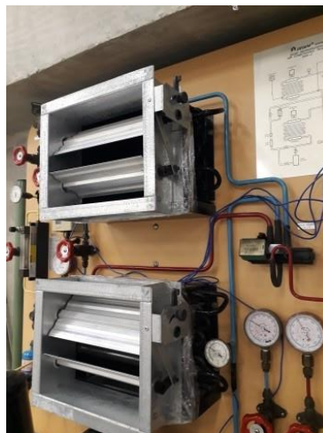
Figura 1 – Máquina de refrigeração adaptada com reguladores de vazão do tipo damper
