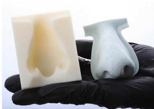
Figura 128: Molde nasal impresso em ABS e modelo teste em silicone gerado a partir dele
