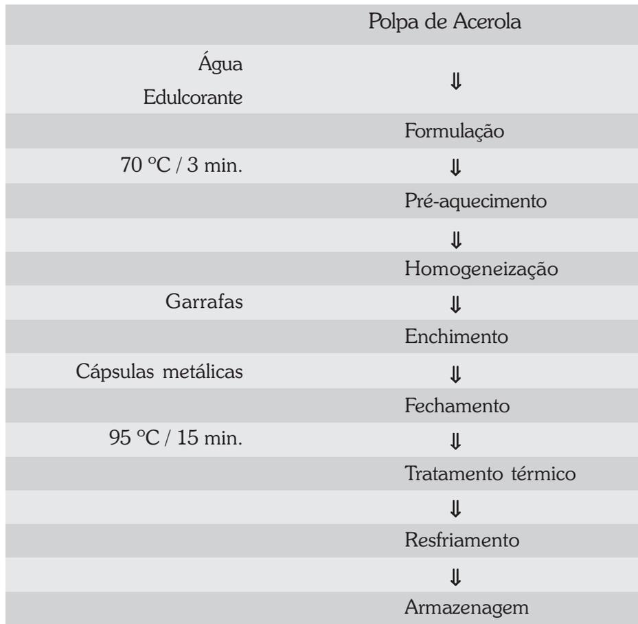
Figura 1 - Fluxograma de processamento da bebida de baixa caloria à base de acerola.
