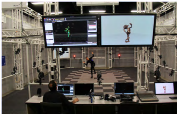
Figura 9.3. Típica utilização da captura de movimento no cinema e videogames: os movimentos de um ator são capturados e usados para guiar um personagem animado.
