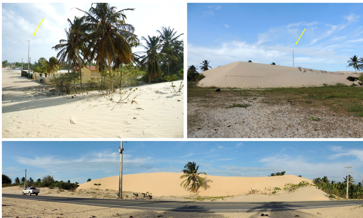
Figura 3 – Estrutura da Escola de Ensino Fundamental Nossa Senhora do Perpétuo do Socorro em 2012 e posterior ao processo de soterramento da escola (seta amarela) e de trecho da CE-187 na localidade do Venâncio
