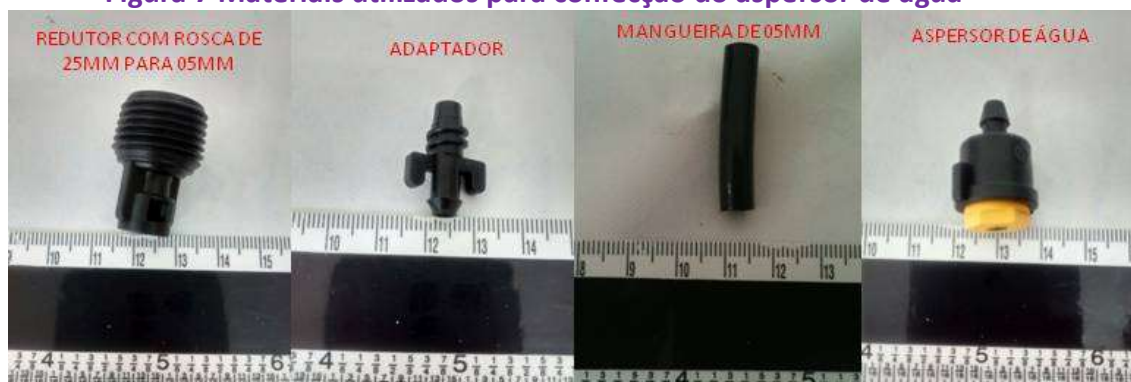
Figura 7 Materiais utilizados para confecção do aspersor de água
