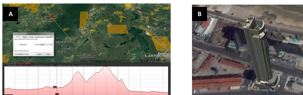
Figura 8 – A: Perfil indicando elevações de um percurso traçado no terreno. B: Visualização tridimensional de edificações, considerada para modelos digitais superfície.
