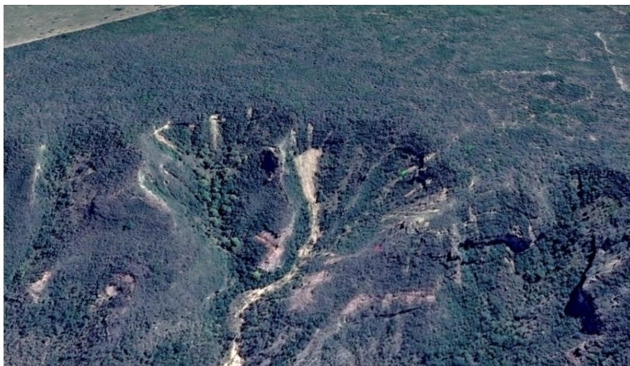
Figura 2 - Exemplo de imagem de satélite utilizada para localização de cicatriz de escorregamento na escarpa sul da Chapada do Araripe (município de Exú, semiárido de PE). Fonte: Base de dados do software Google Earth Pro (2018).
