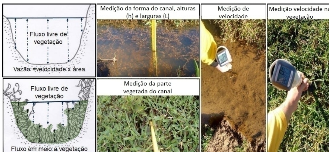
Figura 2 - Monitoramento do avanço da vegetação do canal e da velocidade do fluxo em meio ao canal livre e vegetado. A presença da vegetação não significa que a água parou de circular, mas que a dinâmica de fluxo agora opera influenciada por obstáculos como hastes e folhas. Fonte: Silva, 2018
